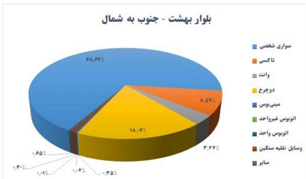
شکل ۳-۹۵: درصد سهم وسایل نقلیه شمارش شده در ایستگاه بیستم خط برش در جهت جنوب به شمال
